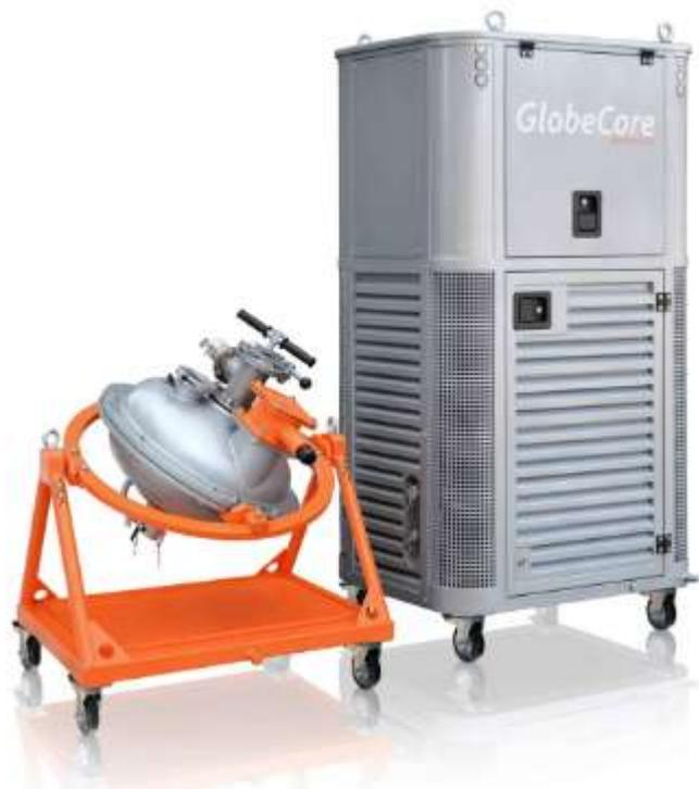
Смесительная машина работает по принципу преобразования энергии электромагнитного поля в другие формы энергии. Агрегат представляет собой камеру (трубопровод) диаметром 90-136 мм, расположенную внутри вращающегося индуктора электромагнитного поля.
