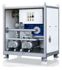
для блок **BV-3000** предназначен Вакуумный вакуумирования трансформаторов. Устройство может использоваться при монтаже. обслуживании и эксплуатации маслонаполненного оборудования (силовых трансформаторов, высоковольтных выключателей и т.п.) напряжением до 1150 кВ. БВ-3000 применяется также для вакуумирования и сушки трансформатора. Изделие используется предприятиями, которые занимаются установкой, ремонтом и обслуживанием трансформаторов и другого маслонаполненного оборудования.
