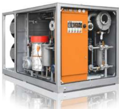
Установка СММ-1СО предназначена для удаления твердых частиц, газа и влаги из кабельного масла, для хранения порций подготовленного кабельного масла и для добавления масла в силовые кабели с напряжением до 500 кВ. Устройство также может быть использовано для вакуумирования трансформаторов и другого оборудования. Устройство может обрабатывать кабельное масло со следующим начальным качеством:
