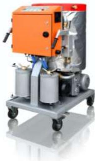
**Станция масляная мобильная СММ-2,2ЛТ** предназначена для комплексной очистки (термовакуумной сушки, фильтрации, очистки от механических примесей, очистки от воды) трансформаторных, турбинных, гидравлических и других масел. Установка может быть использована для нагрева маслonaполненных электрических аппаратов горячим маслом, вакуумной осушки трансформаторного масла. Установка применяется в монтажных, ремонтных и эксплуатационных организациях, занимающихся обработкой масел.
