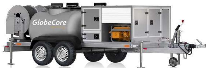
Установка СММ-G предназначена для трехэтапного процесса замены масла в **редукторах ветряных турбин** (слив старого масла, промывка редуктора и заливка нового масла). Установка позволяет быстро и эффективно обслуживать масляную систему ветряной турбины. Агрегат может использоваться для обслуживания ветряных турбин многих различных производителей. СММ-G также может нагревать чистое масло.
