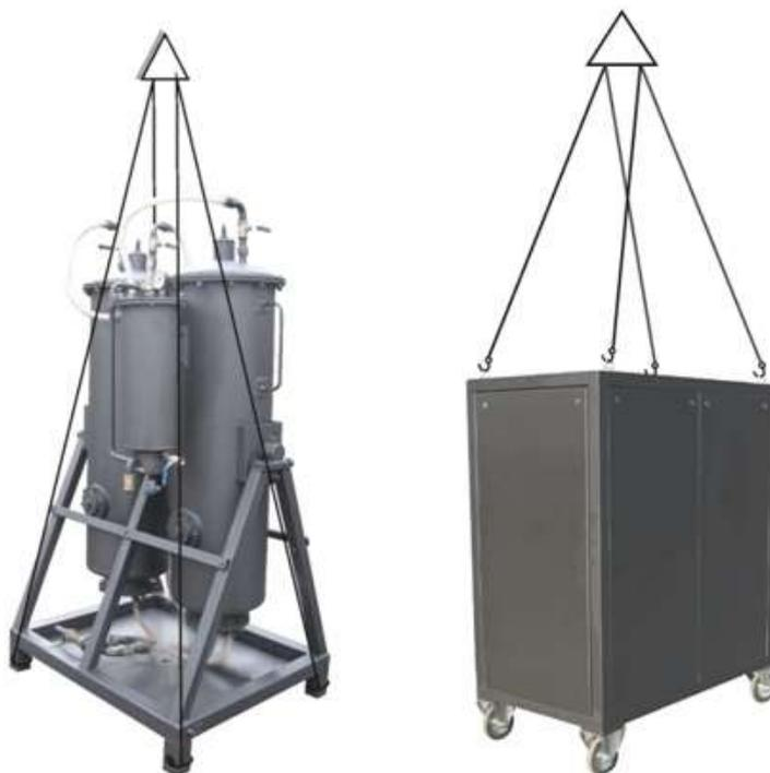
Рисунок 5 – Схема строповки
