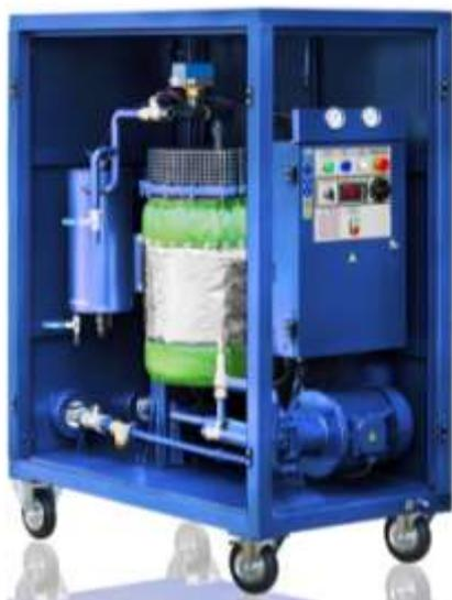
**Установка сушки масла цеолитовая MSU-4,3** предназначена для очистки от механических примесей и очистки от воды и снижение кислотности, электроизоляционных масел, вязкость которых при температуре 50°С не превышает 70сСт.
