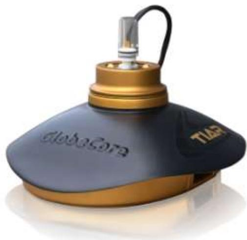
Устройство предназначено для определения тангенса угла диэлектрических потерь и диэлектрической проницаемости трансформаторных масел и других диэлектрических жидкостей в соответствии с IEC 60247. Это полностью автоматическое устройство, которое позволяет проводить испытания в соответствии с процедурами, определенными в этих стандартах, а также в соответствии с процедурами пользователя, указанными в соответствующем разделе меню настройки.
