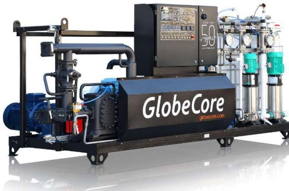
Установка для приготовления битумных эмульсий UVB-1M предназначена для получения как катионовых, так и анионовых битумных эмульсий.
