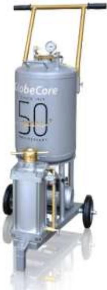
Установкой UVD-4 выполняется доливка трансформаторного масла высоковольтных маслонаполненных герметических вводов при монтаже, ремонте и в процессе эксплуатации силовых трансформаторов и выключателей, используемых на электростанциях, подстанциях и других энергетических предприятиях.
