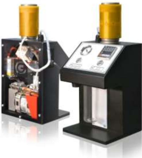
Контейнер для фильтрации представляет собой сосуд, наполовину заполненный **сорбентом**, который регенерирует фильтрующее масло. Сорбент и масло загружаются в контейнер сверху. Дно контейнера имеет крышку, через которую контейнер откачивается и из которой извлекается насыщенный сорбент. Регенерированное масло также откачивается снизу.
