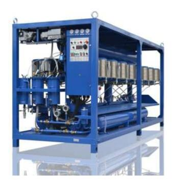
UVR – это универсальная установка, которая предназначена и используется для: регенерации и восстановления различных типов масел, трансформаторных, турбинных, индустриальных а так же для осветления топлива, темного дизельного топлива, осветление темного печного топлива, газового конденсата, бензина, керосина и т.д.
