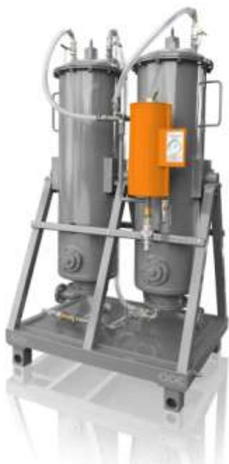
Блок сорбентных патронов ZP-260 (в дальнейшем – блок) предназначен для очистки от механических примесей и осушки смазочных и электроизоляционных масел, вязкость которых при температуре 40°С не превышает 70сСт.
